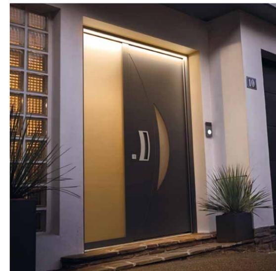
EURALED est un système d'éclairage extérieur intégré dans la tapée de doublage supérieure de la porte d'entrée.
